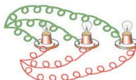
படம் 13 - பல்புகள் பக்க இணைப்பில் கணக்குப்பட்டுள்ளது
