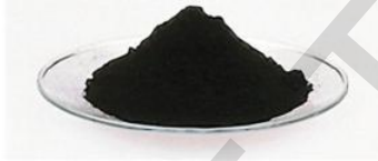
شکل- 15(a) سیاہ رنگ میں تبدیل ہوا کارپا آکسائیڈ
